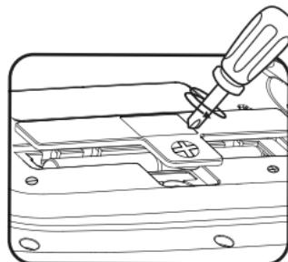
3. Se sono presenti batterie usate, rimuovere le batterie dal dispositivo premendo sull'estremità di ogni batteria.
