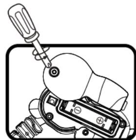
5. Riposizionare il coperchio della batteria e serrare la vite per fissarla.
