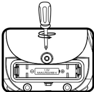
4. Installare 1 batteria LR03/AAA nuova seguendo lo schema all'interno dello scomparto delle batterie. (Per avere prestazioni migliori si consigliano batterie alcaline o ricaricabili Ni-MH completamente cariche.)
